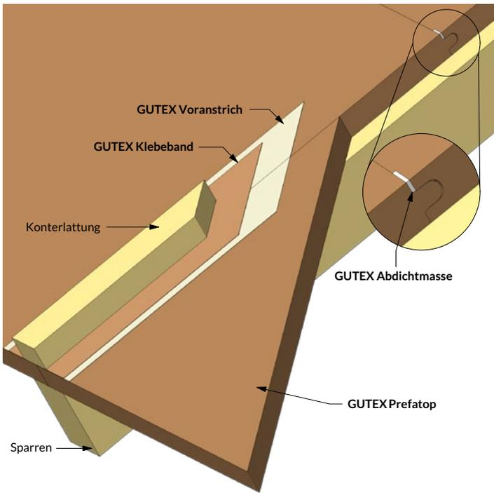
Stoßdetail/-abdichtung bei Dachelementen mit GUTEX Prefatop (Detail 1.1.601)
