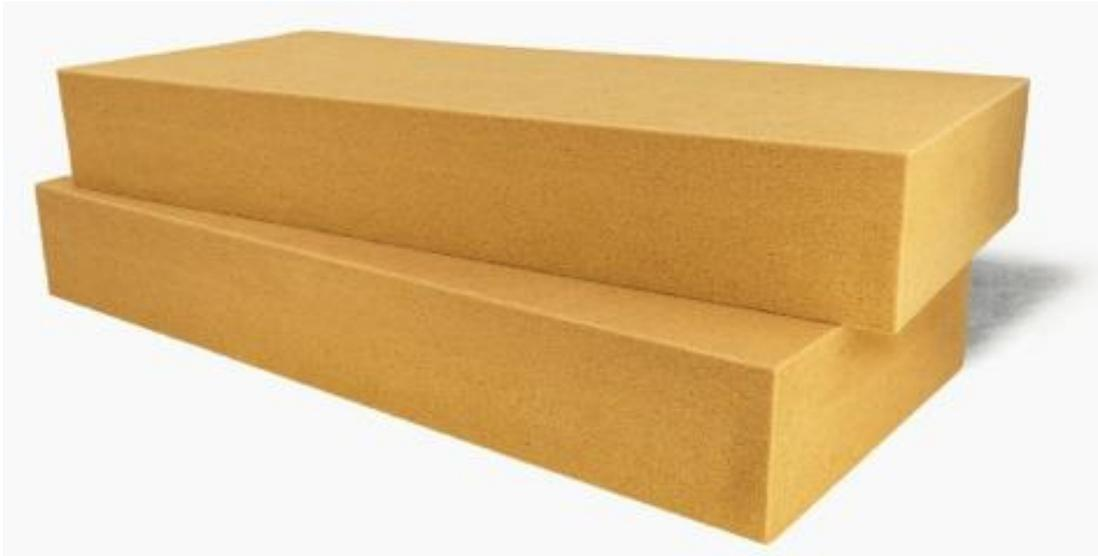
*GUTEX Thermoflex<sup>®</sup>, die flexible Holzfaserdämmmatte für Zwischensparren- und Gefachdämmungen, besitzt mit 0,036 W/mK eine außerordentlich geringe Wärmeleitfähigkeit. Foto: GUTEX*
